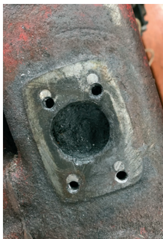
Boltene til termostathuset var umulige at løsne, de blev savet over og nye huller boret, samt skåret gevind.
