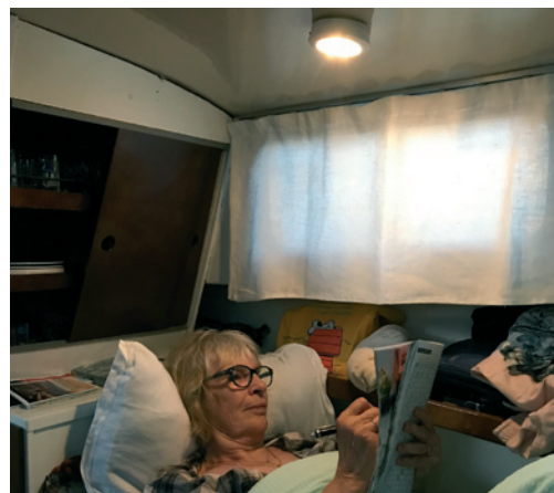
Tv. Kahytsdørene er de originale bortset fra fyldningerne som er ny 2 mm teakplader, som også er brugt til hylterne. Lugen er ny, og indvendig i loftet er der lavet en ramme af teakplywood.
