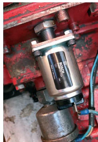
Stopmagnete monteret. Efter nogle justeringer på møtrikken, fandt jeg det rigtige tryk.
