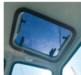
Tv. Kahytsdørene er de originale bortset fra fyldningerne som er ny 2 mm teakplader, som også er brugt til hylterne. Lugen er ny, og indvendig i loftet er der lavet en ramme af teakplywood.
