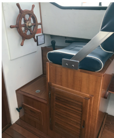
Tv. Kahytsdørene er de originale bortset fra fyldningerne som er ny 2 mm teakplader, som også er brugt til hylterne. Lugen er ny, og indvendig i loftet er der lavet en ramme af teakplywood.
