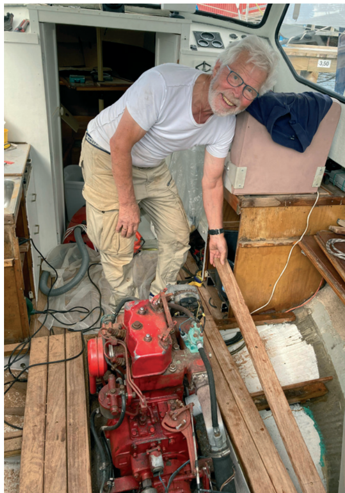
Renoveringen startede med at jeg lagde nye hårdtræ (cumaru) planker i cockpitet. Plankerne blev savet midt igennem og afrundet på siderne. Skruerhullerne er proppet og træet blev lakeret 4 gange.
