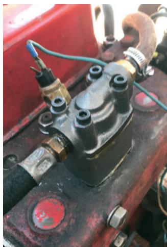
Den nye termostathus monteret med nye pakninger og de nye bolte.
